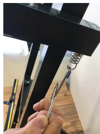
熱線の取り付け・交換 専用フックを使用し、上下二つのスプリングを同時に引き、熱線のテンションを緩め着脱します。 (スプリングの引き過ぎに注意)
